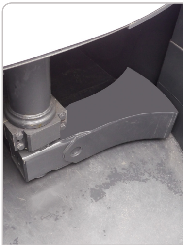
Verdichtung mit Schwenkpaddel
