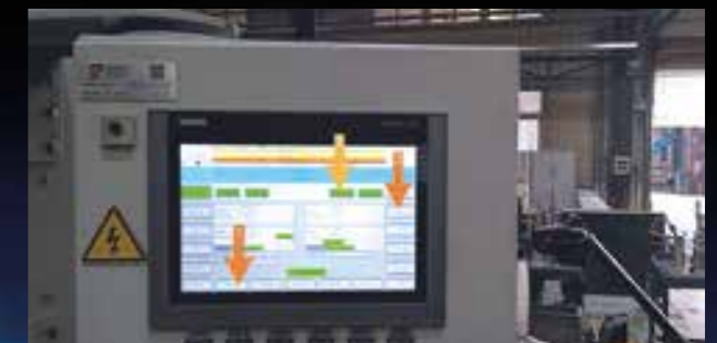
Online-Ansicht des Spezialisten auf die Umgebung des Anwenders. Der Spezialist kann visuelle Hinweise einfügen, welche mittels der Brille direkt in das Sichtfeld des Anwenders projiziert werden.
