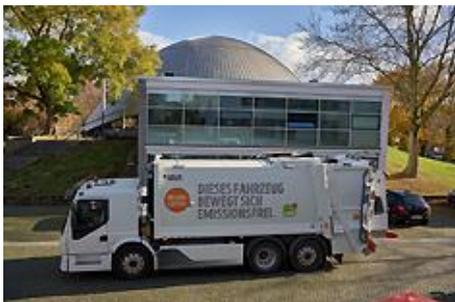
Kein Verbrenner über der Vorderachse. Das schafft Platz für einen niedrigen Kabinenaufbau.
