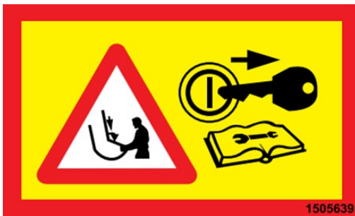
Obligatorisches Abschalten des Motors und Abziehen des Zündschlüssels vor Beginn von Wartungsarbeiten
