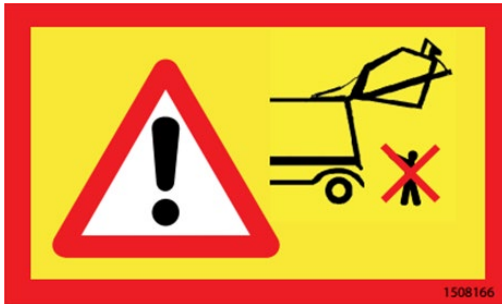
Verbot des Aufenthalts unterhalb des Heckteils
